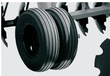
Rodeiro duplo com pneu 7.50x16 para os modelos CRSG 32 a 48 discos.
