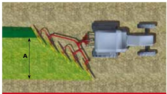
Los modelos RP2C/3C con enganche para tractores pequeños. BS: Brazo bastidor con división que permite el transporte por carretera, incluso con tractores de baja potencia.
