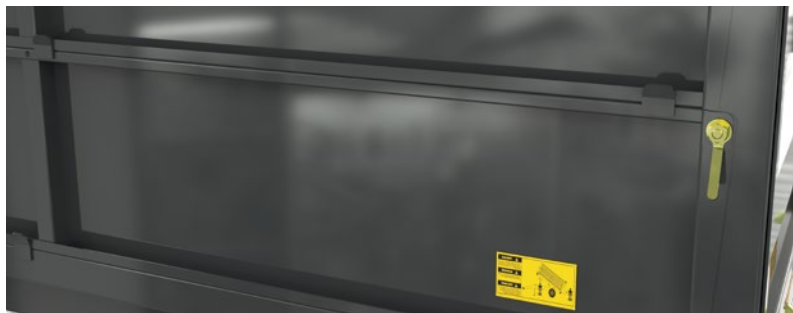
Sistema de montagem das tampas por meio de travas permitindo ajuste de tamanho de acordo com a necessidade. The walls are detached by locks that allow adjusting the wagon capacity. Sistema de armado de las tapas con trabas, permitiendo ajustar el carro de acuerdo con la necesidad.
