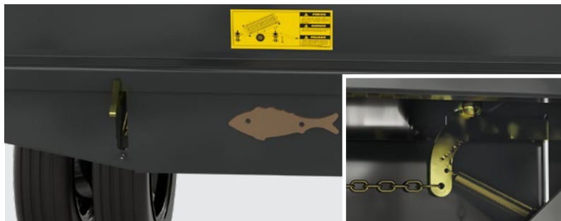
Sistema de desarme e rearme por meio de trava de segurança. Open and close system by safe device. Sistema de desarme y rearme a través de traba de seguridad.
